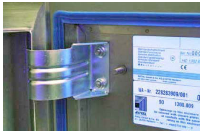
Figura 14 Después del ensayo en un armario HD, se ha eliminado toda la contaminación sin dejar ningún residuo.
