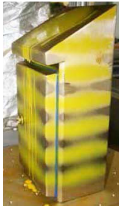
Figura 12 La contaminación del armario HD durante el ensayo.
